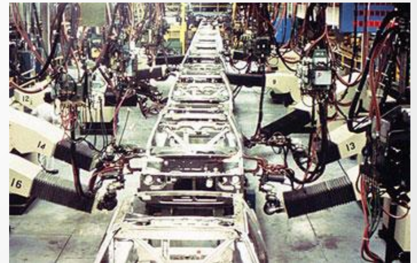
A GM em 1961 instalou a primeiro linha de robôs de solda do mundo com tecnologia do Unimate
