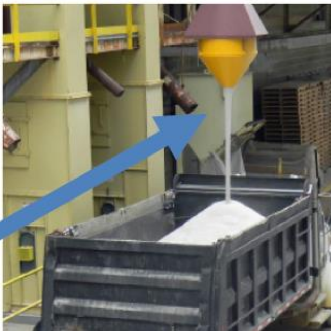
Fig.2 – Carregamento de açúcar sobre caminhão utilizando o funil direcionador e suportes típicos
