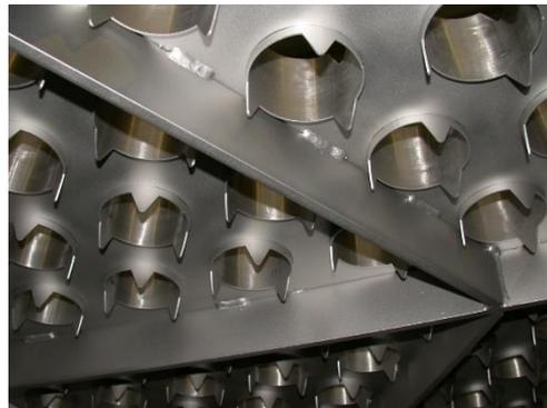
Distribuidor de 2 Bandejas com **passagem de Vapor Flash do caldo**
