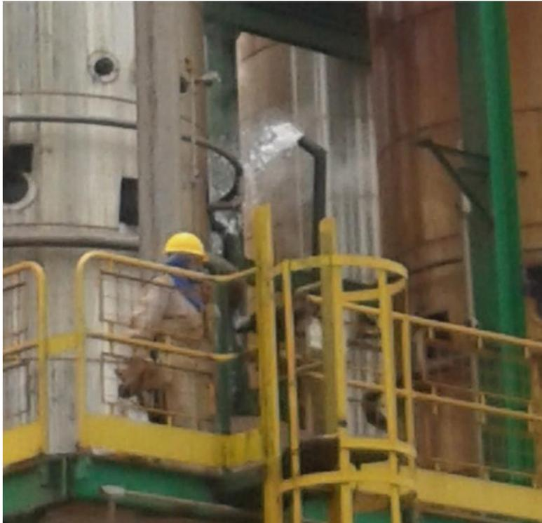
Saída de Condensado pela degasagem do evaporador, especialmente nas partidas depois da limpeza
