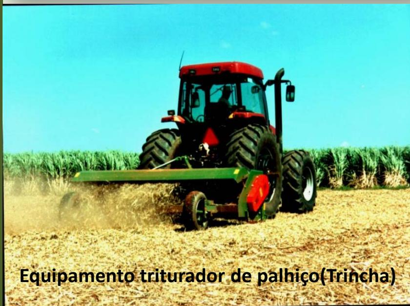
Equipamento triturador de palhicho (Trincha)
