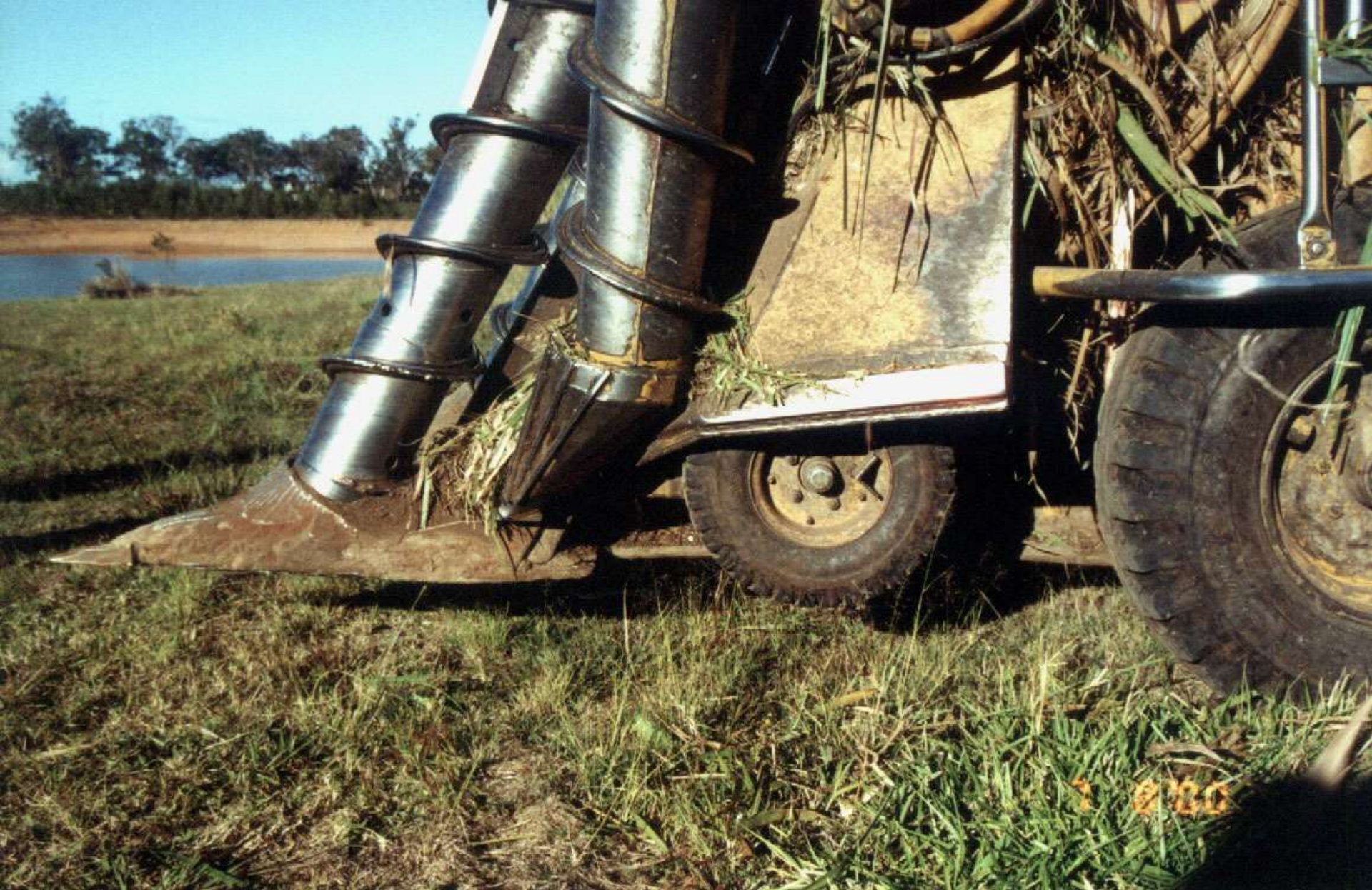
Rodinha no divisor de linhas num protótipo na Austrália
