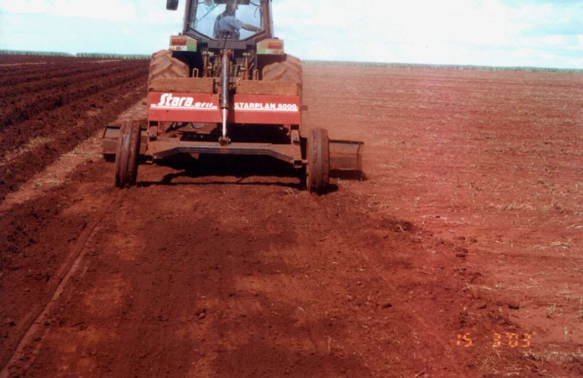
Plaina niveladora alisando o terreno antes da sulcação
