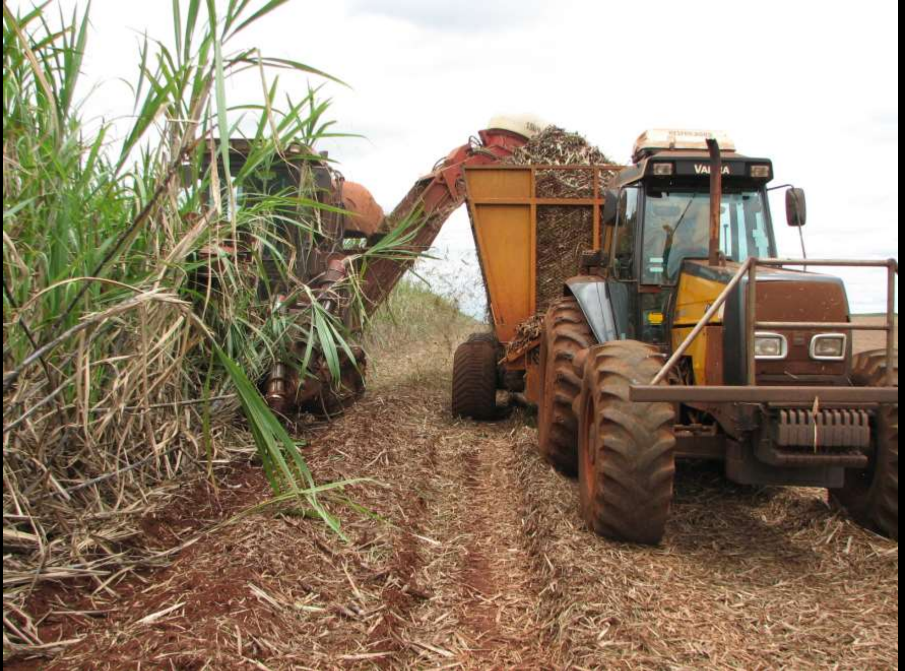
Equipamentos da colheita com bitolas diferentes no espaçamento de 150 cm
