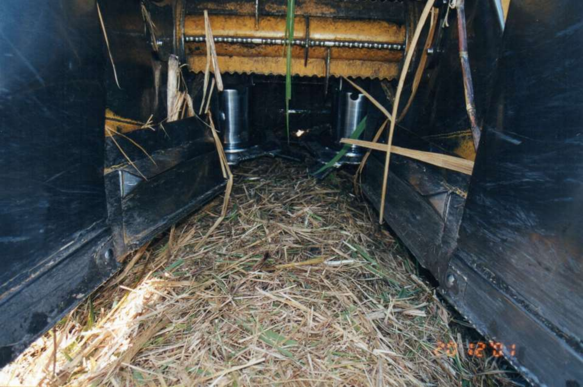
Chapa flutuante que deixa estreita a passagem de cana na frente do corte de base
