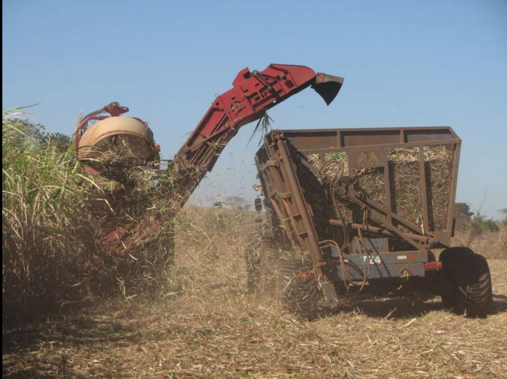
Elevador sem o extrator secundário
