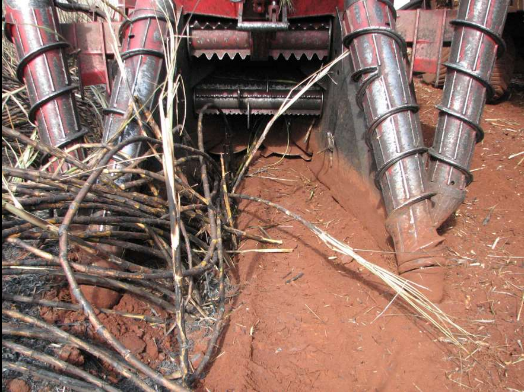
Biqueira e divisor de linhas levantando as canas acamadas
