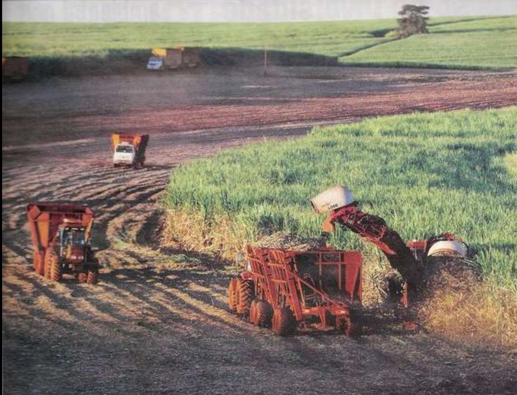
Equipamentos da colheita com bitolas diferentes no espaçamento de 150 cm
