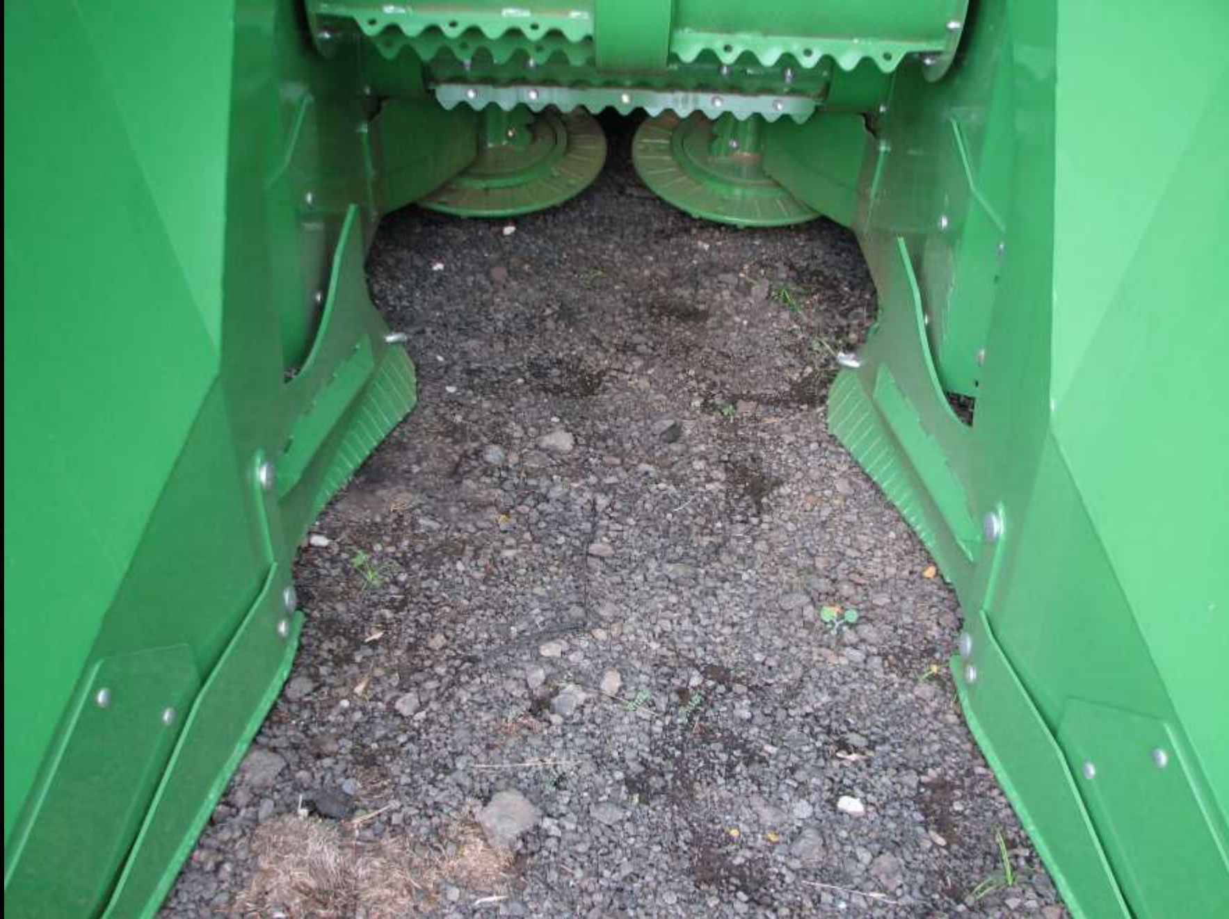
Chapa flutuante que deixa estreita a passagem de cana na frente do corte de base
