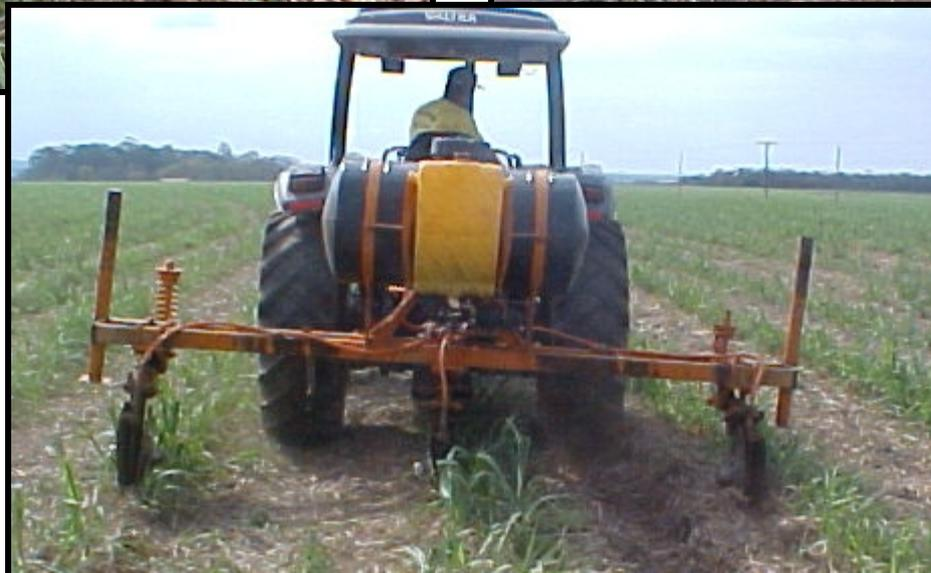
1. O desaleiramento da palha da linha de cana, após a colheita facilita a aplicação (cortando a soqueira) e melhora a performance dos produtos;
