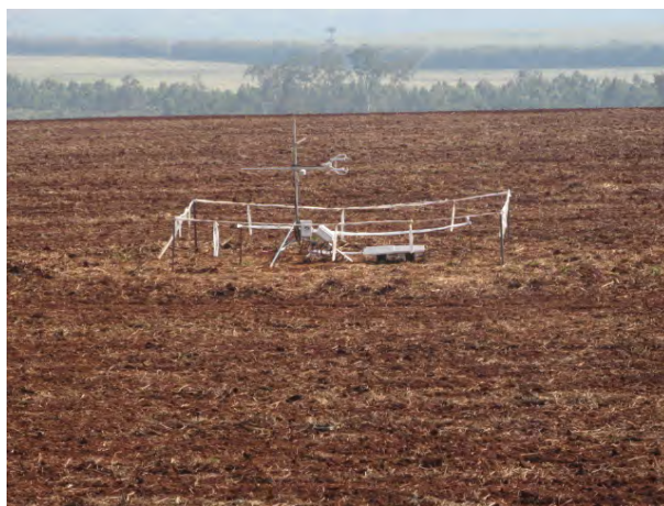
Figura 1. Área da reforma em Pirassununga (SP), com o sistema de medição de fluxos de CO 2
