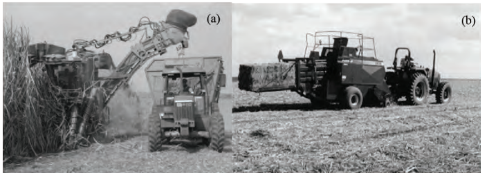
Figura 1. Sistemas de recolhimento de palha de cana-de-açúcar: (a) colheita integral, (b) enfardamento (Fonte: HASSUANI et al. , 2005)
