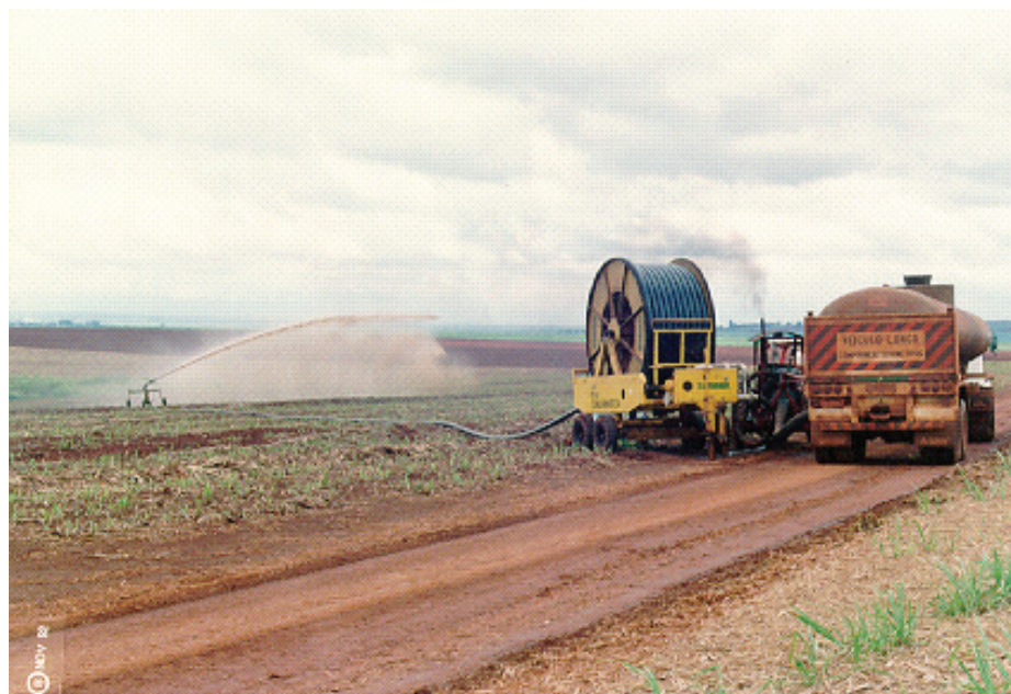
FIGURA 6. TRANSPORTE DE VINHAÇA POR CAMINHÃO E DISTRIBUIÇÃO POR ROLÃO.
