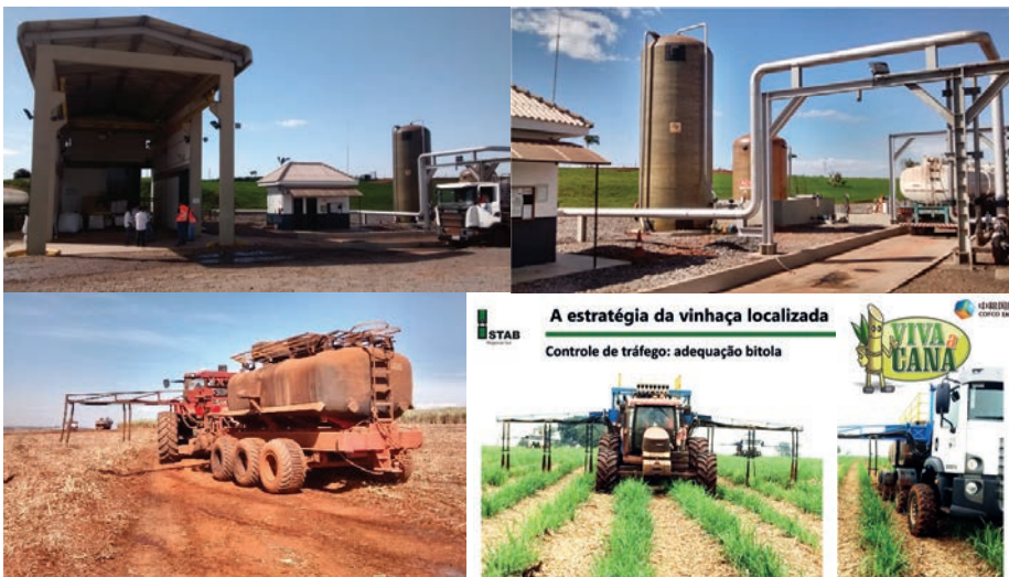
FIGURA 7. FABRICA DE MISTURA DE ADUBOS, CARREGAMENTO E DISTRIBUIÇÃO DA VINHAÇA CONCENTRADA ENRIQUECIDA.
