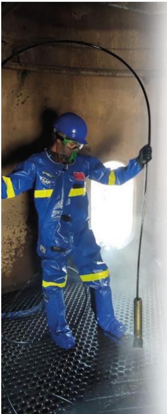
A operação de Hidrojateamento é uma das mais versáteis e eficientes métodos de manutenção industrial do mercado, porém uma das mais arriscadas, uma vez que o jato pressurizado a Ultra Alta Pressão pode causar sérias lesões e até acidentes fatais.
