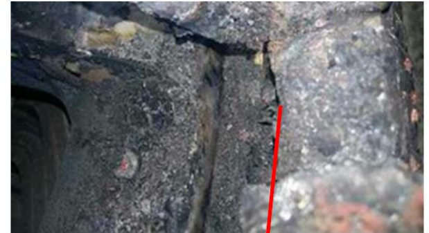
Cama isolante separadora de barras de fundo e topo de ranhuras
