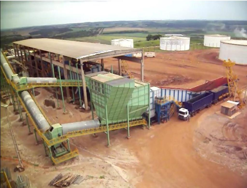
Dificuldades operacional em operar com Sistema de sopragem normal. Hoje opera com apenas uma câmara soprando, deficiência na mistura bagaço/palha provocando bucha e deficiência na selagem dos alimentadores de bagaço.
